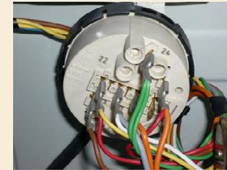
Cuando se alcanza el nivel de agua requerido el terminal acabado en 1 hará contacto con el acabado en 3, terminando así la alimentación eléctrica de las electroválvulas y dando paso al funcionamiento de la resistencia para el calentamiento de agua y al motor que mueve el programador para avanzar en el ciclo de lavado.
